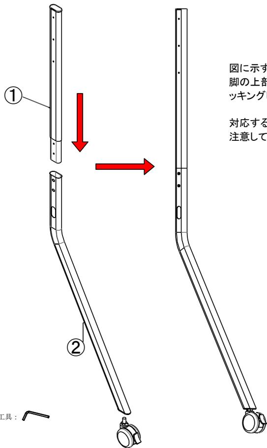
図に示すように、長脚の上部と下部をドッキングします。
