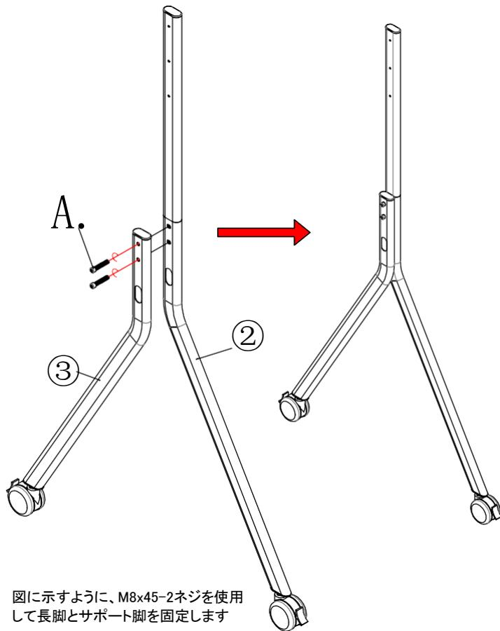
図に示すように、M8x45-2ネジを使用して長脚とサポート脚を固定します
